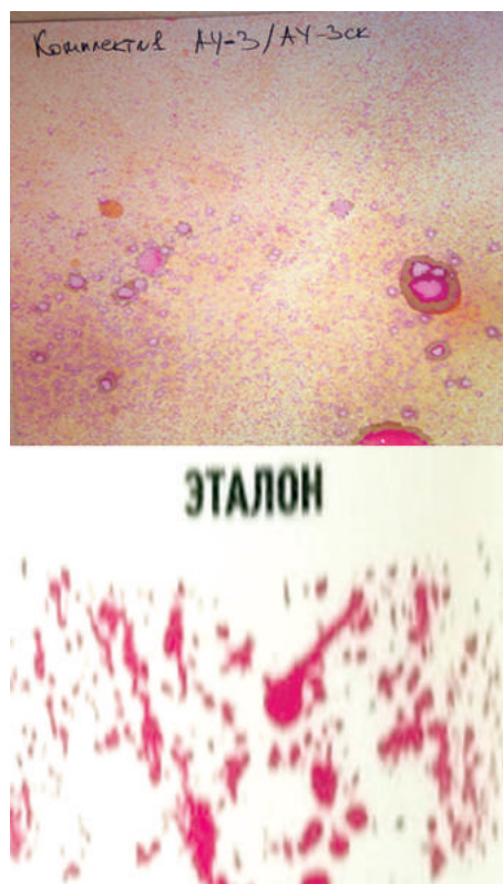
Рис. 18. Характер индикационного эффекта от агрессивных химических веществ кислого характера
