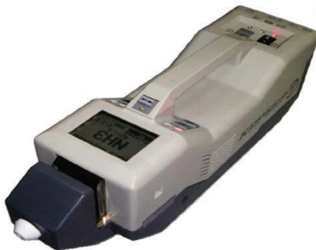
Рис. 12. Ион-дрейфовый детектор «Кербер-Т»
