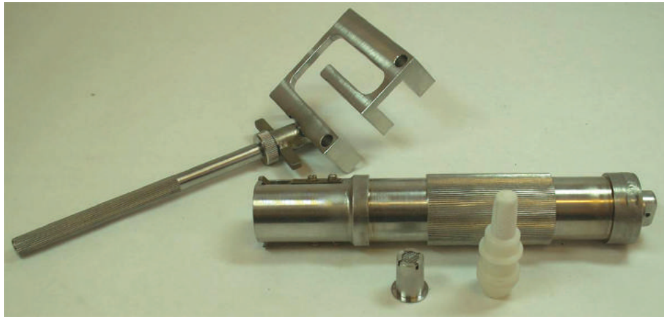
Рис. 5. Пробоотборный элемент с устройствами отбора пробы
