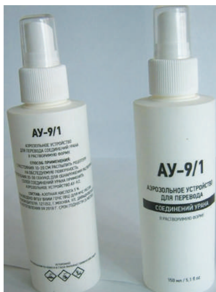
Рис. 23. Аэрозольное устройство для перевода нерастворимых соединений урана в растворимую форму (АУ-9/1)
