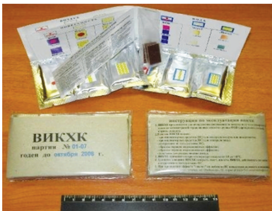
Рис. 2. Войсковой индивидуальный комплект химического контроля ВИКХК
