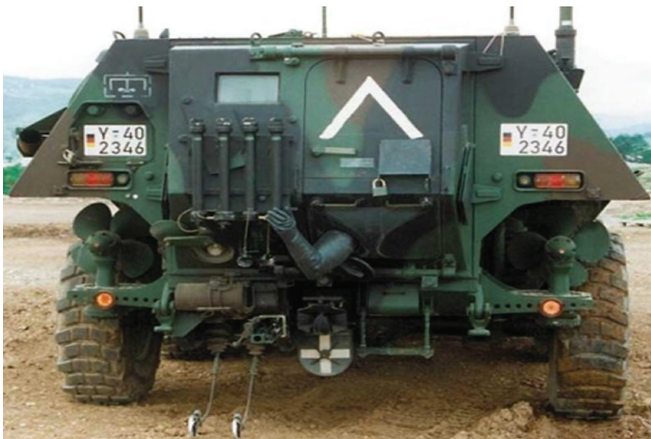
Рис. 7. Внешний вид захватывающих элементов типа «колесо» для машины РХБ разведки «Fucks» (Германия)
