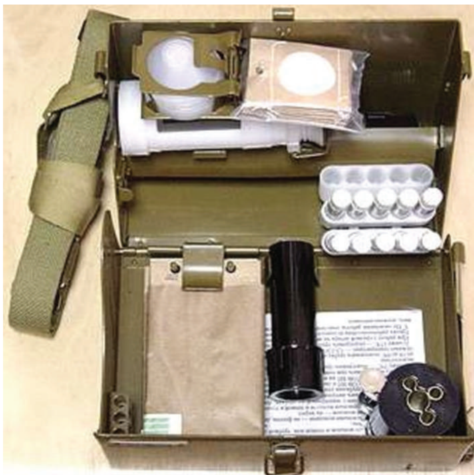
Рис. 3. Войсковой прибор химической разведки ВПХР
