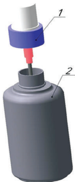
Рис. 13. Аэрозольное устройство: 1 – насос-распылитель, 2 – флакон
