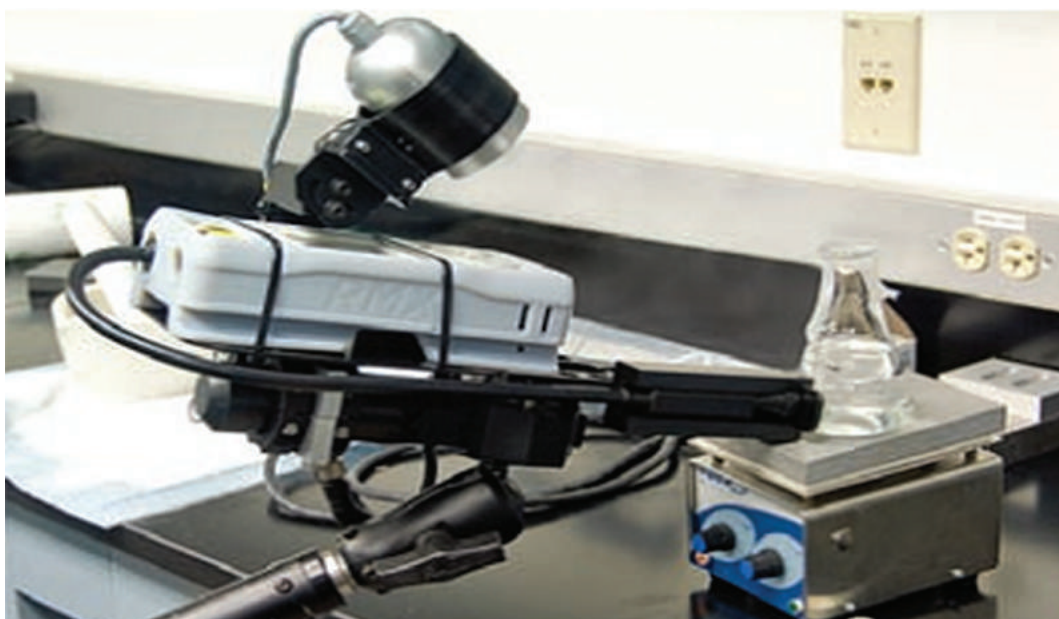
Рис. 11. Установка химического контроля на основе прибора «FirstDefender»
