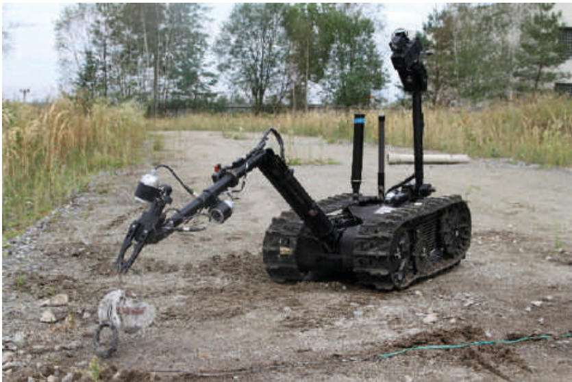
робот для обезвреживания взрывных устройств bomb disposal robot робот за одлагање експлозивних предмета
