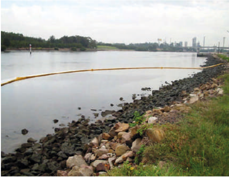
сорбционно-заградительные боны (для задержания и поглощения разлившихся нефтепродуктов) fencing boom (for oil spill localization and absorption) апсорпциони бум (за задржавање изливања нафте и апсорпцију)
