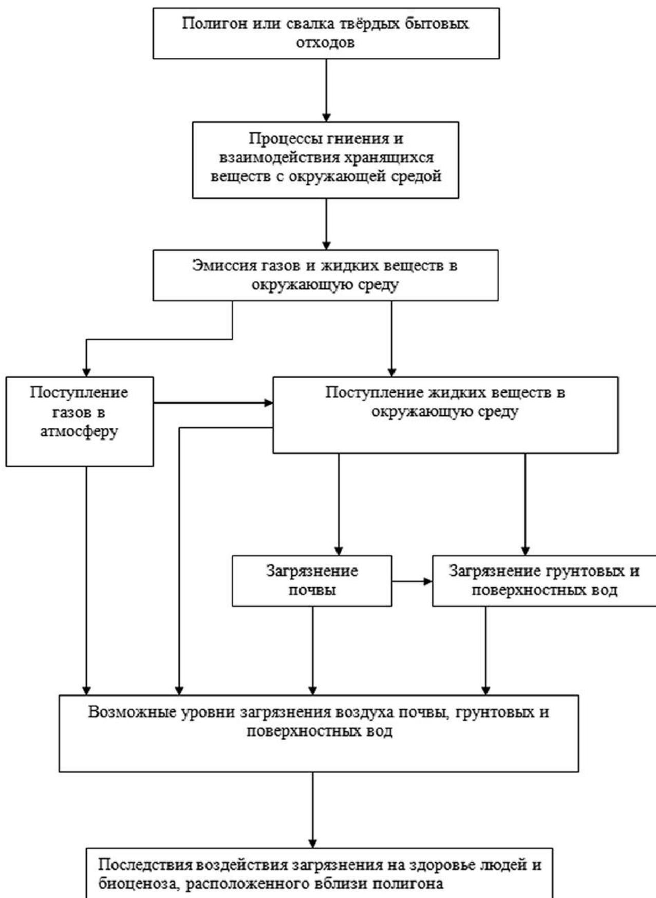
Рис. 2.1. Обобщенная схема воздействия полигонов и свалок твердых бытовых отходов на человека и окружающую среду
