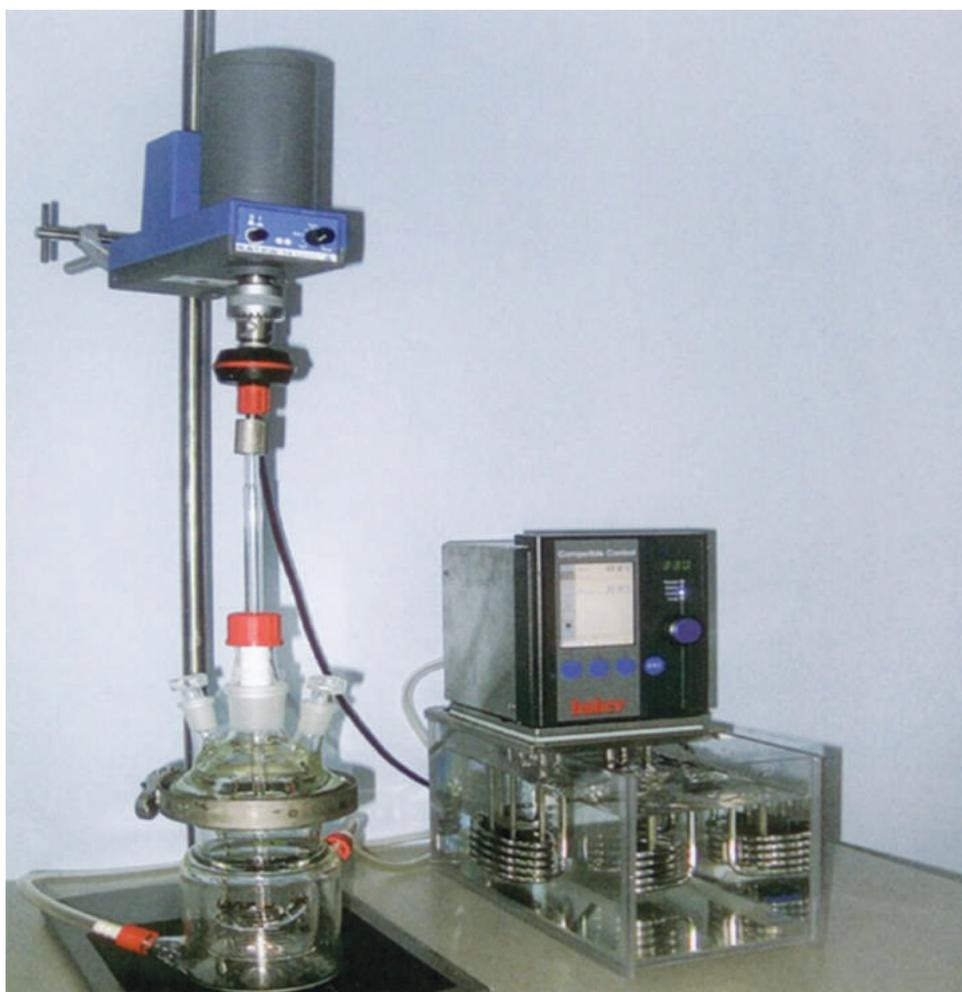
Рис. 42. Установка утилизации гидразина
