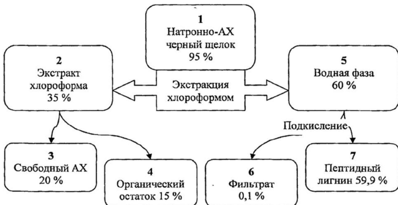
Рис. 35. Схема анализа черного щелока при гидролизе с меченым  $C^{14}$  АХ
