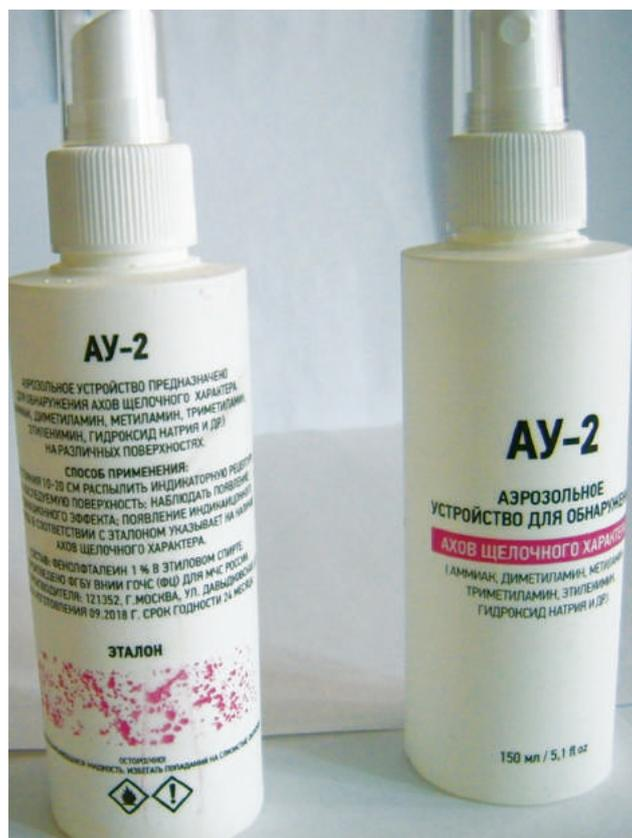
Рис. 3. Аэрозольное устройство для обнаружения агрессивных химических веществ щелочного характера (вид спереди и сзади)
