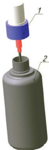
Рис. 1. Аэрозольное устройство: 1 — насос-распылитель; 2 — корпус
